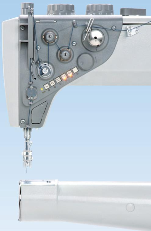
Technische Raffinessen: Das „Jog-Dial“ mit der Funktionalität eines „elektronischen Handrades“, der motorisch angetriebene Spuler mit Anwickelhilfe, eine integrierte Tasterleiste mit Favoritentaster sowie die optional angebotene Fadeneinzugseinrichtung sind nur einige Beispiele der exzellenten Ausstattungsmerkmale.
