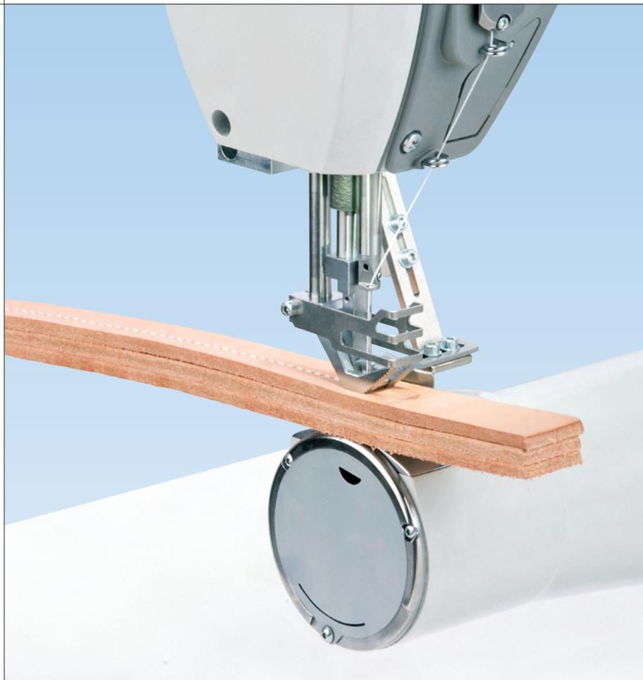
Die besonders robuste Bauweise und der durchzugskräftige Dreifachtransport sorgen für höchste Qualität speziell bei der Verarbeitung extremer Material- und Nähgarnstärken.
